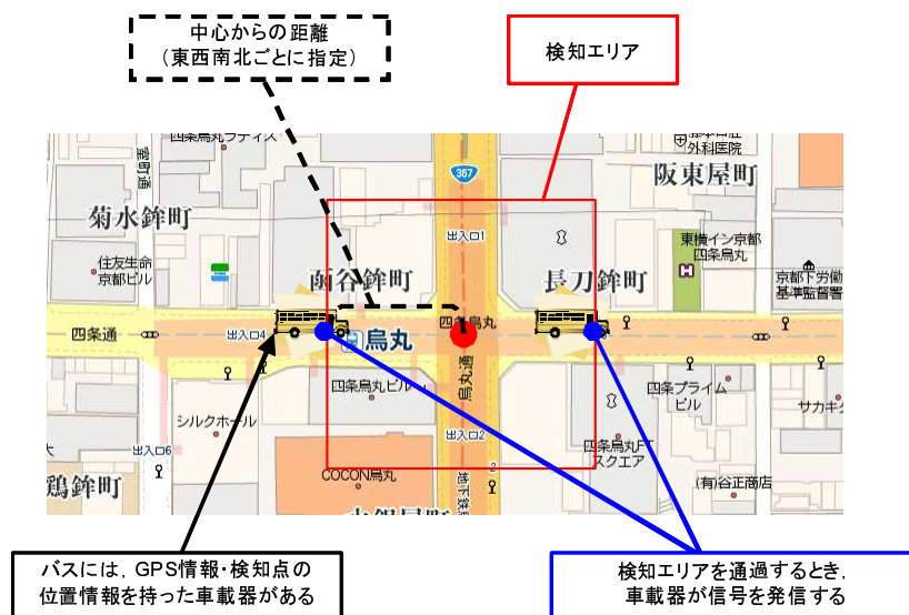
図5: ログデータが記録される仕組み
