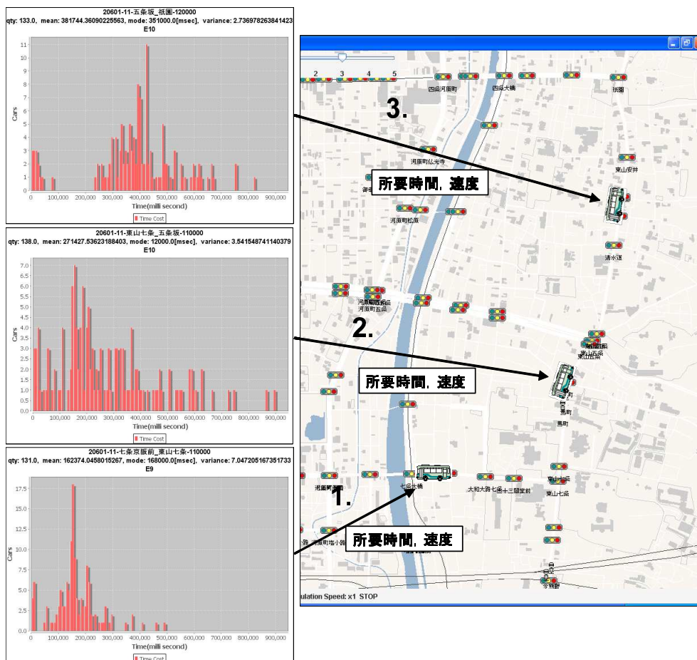
図 18: 速度を与えているグラフとシミュレーションの結果
